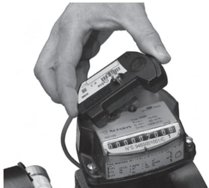
2) Screwing (Max torque: 0,25Nm)
