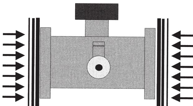
④ Den Zähler spannungsfrei einbauen.
