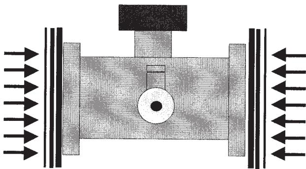
④ Den Zähler spannungsfrei einbauen.
