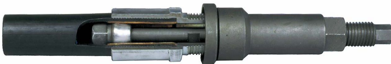
1. ábra Menetes csatlakozású összekötő a kombinált szerelőszerszámmal / metszet /
